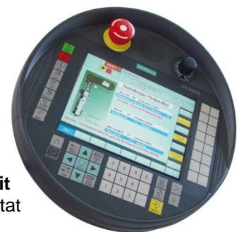
débimètre produits de poteyage visualisation de la répartition des circuits de pulvérisation et affichage des débits
