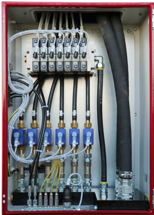
photo: débitmètre produits de poteyage pour 6 circuits de lubrifiant intégré dans le poteyeur
